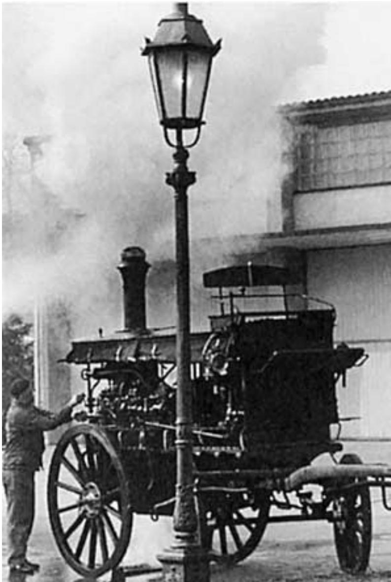
Dampfstrom-Elektrogruppe 1889, für Pferdezug, Leistung etwa 8 kW (10 PS)
